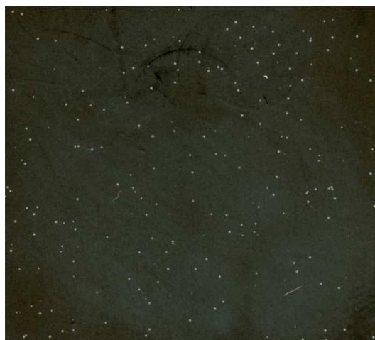
Фигура III.5: Сканирано изображение на черен диск. Преди броенето се превръща в негатив.
