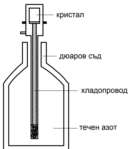
Фиг.56. Схема на конструкцията на Ge детектор (прав).
