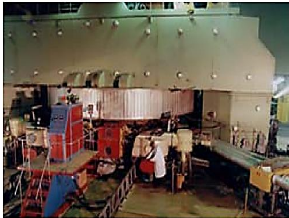
Фиг. П2. 44. Синхроциклотронът за 1 GeV в Института за ядрени изследвания в Гатчина, край Санкт – Петербург ( фотография ИЯФ, Гатчина )
