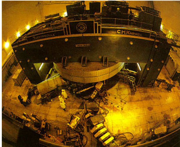
Фиг. П2. 43. Синхроциклотронът за 680 MeV в Лабораторията за ядрени проблеми в Дубна – [7]
