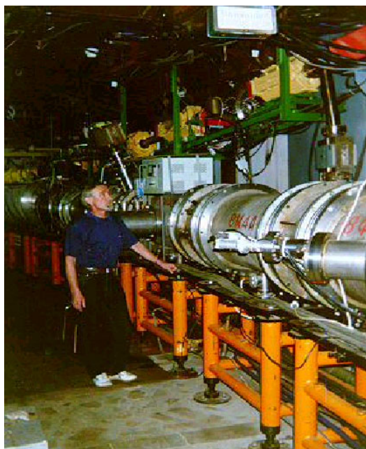
Фиг. П2. 54. Свръхпроводящият ускорител на тежки йони Нуклотрон в ОИЯИ – Дубна – [8]
