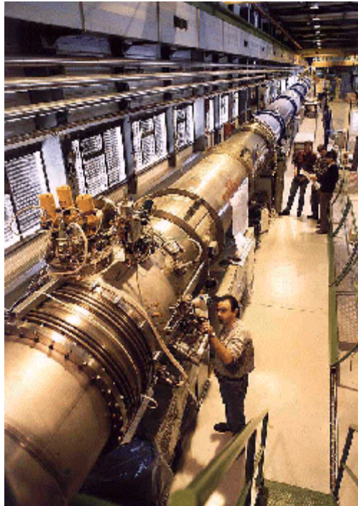
Фиг. П2. 12. Изпитание на свръхпроводящите магнити на LHC – [17]
