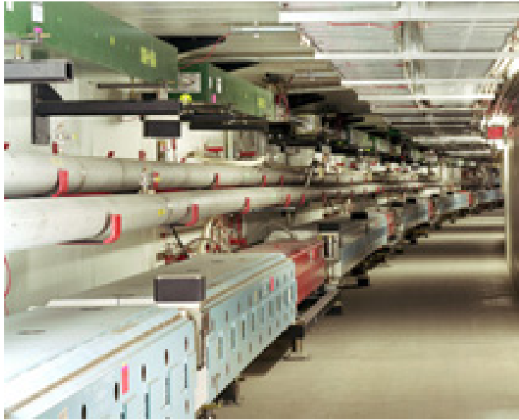
Фиг. П2. 30. Новият синхротрон - инжектор на ускорителния комплекс, наречен Main injector ( фотография FNAL )
