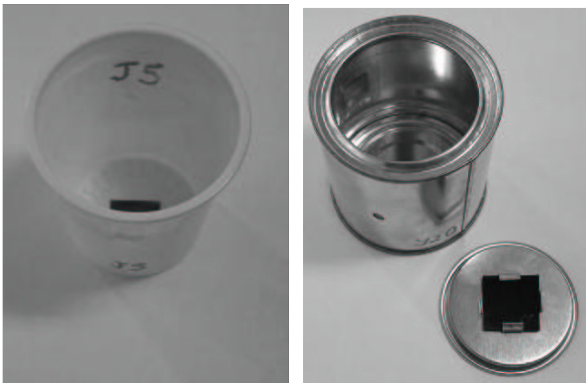
Фигура III.5: Снимки на пластмасова (ляво) и метална (дясно) дифузионна камера.
