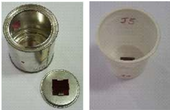
Фигура 1. Използвани във Физически факултет при СУ дифузионни камери с метален (вляво) и пластмасов (вдясно) корпус. Отворът на пластмасовите камери е покрит с полиетиленово фолио, което спира дъщерните продукти пропуска (по дифузионен път) само ^{222}\text{Rn} .
