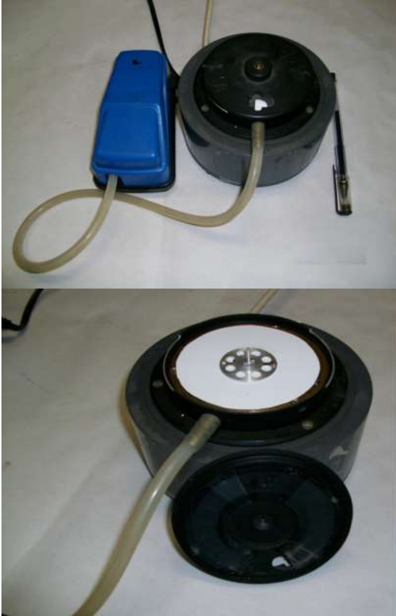
Фигура 6. Прототип на дозиметър тип «въртящ се филтър» с който са направени измерванията дадени в дисертацията.
