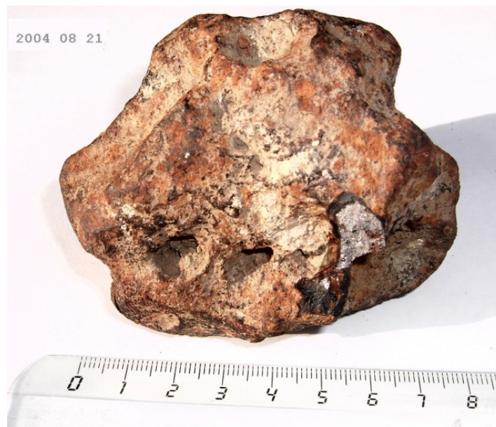
Фиг. III.3.4. Фотография на първия изследван образец. Добре се вижда дебелият окисен слой, както и почистената до метал повърхност.
