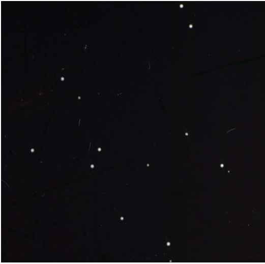
Фигура III.11: Пример за броене с DGTrack при ниски плътности. На изображението са преброени 14 трека, а оценената плътност на треките е 9.7 \text{ tr.cm}^{-2} .
