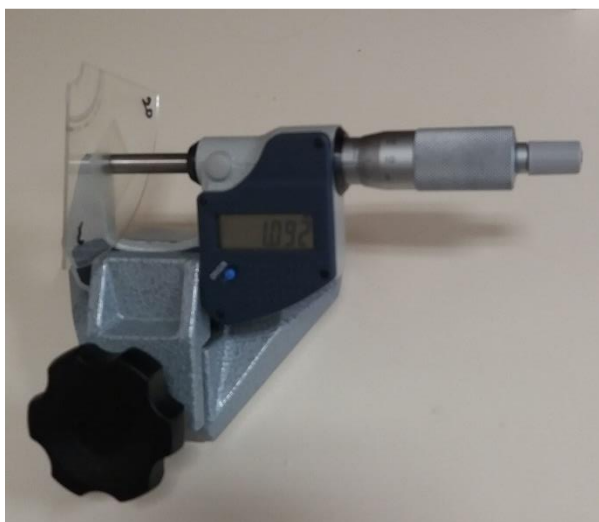
Фигура III.3. Контрол на дълбочината на ецване с микрометър с точност 1 \mu\text{m} .
