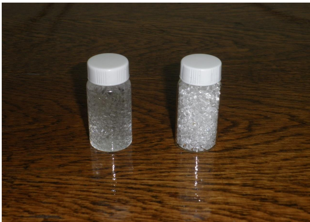
Фигура 14. Снимка на шишета за сцинтилационно броене, използвани в настоящите експерименти
