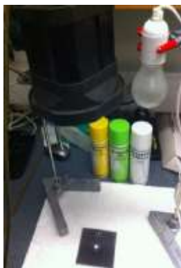
Фиг. 10. Комплект материали за провеждане на капиларен контрол /почистващо средство, пенетрант, проявител/ [9]
