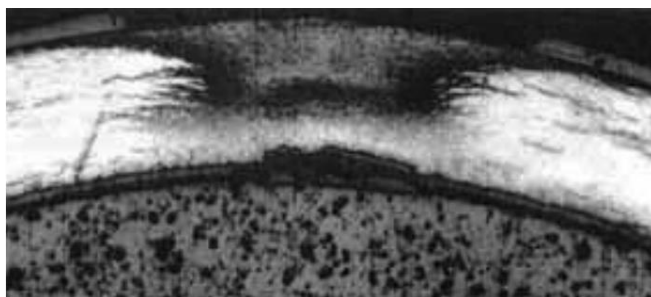
Фигура 3.6. Масивно локализирано наводородяване [9]
